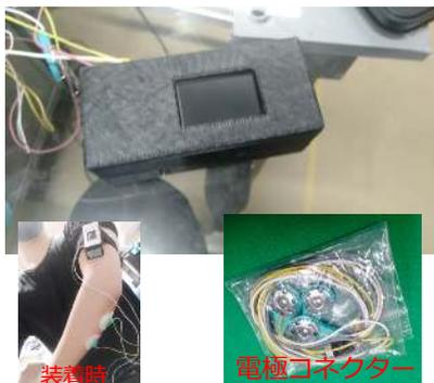
乾電池型マイコン搭載5v筋電センサー試作機一号
