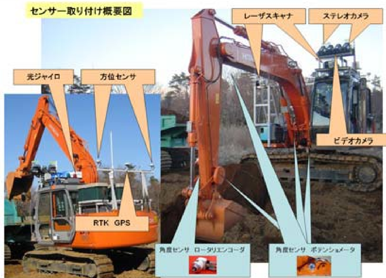
油圧ショベル外観とセンサ取付図
