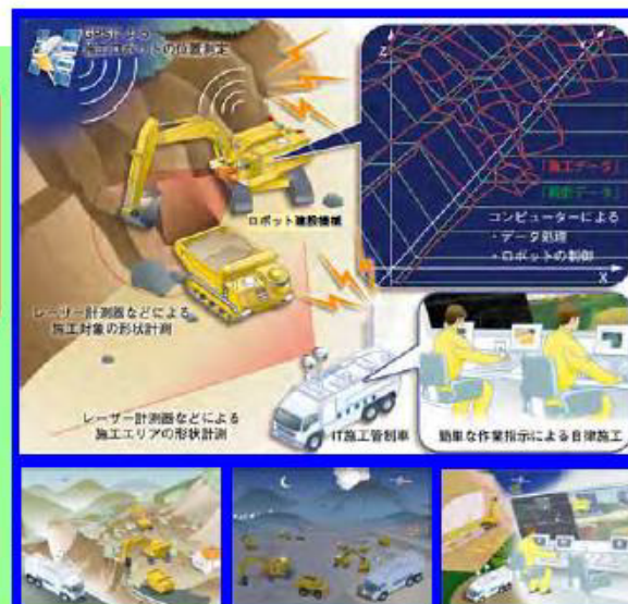
次世代ロボット建設機械による施工技術
