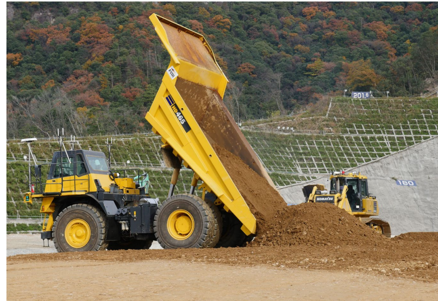
自動ダンプ・ブルの協調作業(鹿島建設提供)
